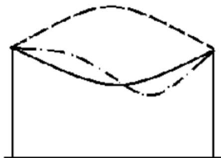
1.8 – сурет. Сымдардың аралықта секіру толқыны
